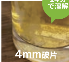
パイプ内のスケール破片溶解実験
